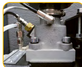
Regulador de aspiración Sistema electro-neumático normalmente abierto. Regula el funcionamiento del compresor garantizando la mínima presión necesaria durante la marcha en vacío, para lograr el máximo ahorro energético
