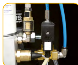
Transductor de presión Garantiza un funcionamiento cuidadoso y estable. Permite modificar la presión de trabajo directamente del controlador electrónico sin ninguna intervención mecánica
